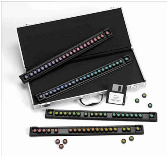
Figure 5.6. : Test de Farnsworth-Munsell 100-hue : est un test de discrimination, permettant de quantifier la capacité de différencier les couleurs, en faisant classer des pastilles des jetons dans un ordre consécutif en fonction de leur teinte.
