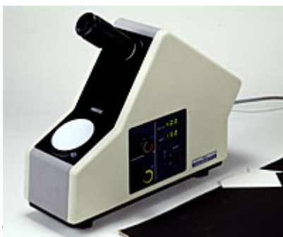
Figure 5.5. : Anomaloscope : Appareil qui permet de tester la vision dans la zone rouge-vert, dont le principe repose sur la comparaison sur un écran, d'une lumière de référence jaune orangée (partie haute de chaque disque) avec une lumière composée d'une addition de rouge et de vert (partie basse de chaque disque).
